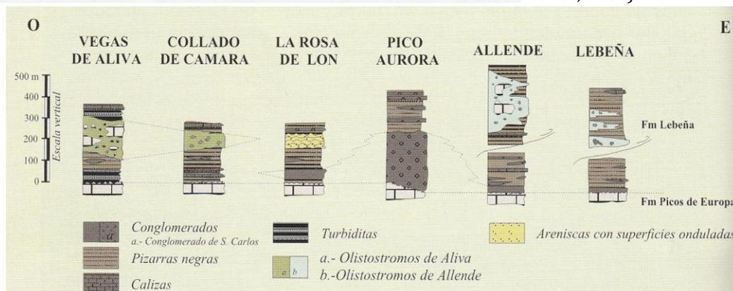
**Figura 7.10.** Columnas estratigráficas esquemáticas de la Formación Lebeña realizadas a lo largo de la Unidad Frontal, en las que se muestran los importantes cambios de facies existentes. Es de destacar la existencia de cantos calcáreos de la Fm. Picos de Europa y de la propia Fm. Lebeña dentro de los olistostromos de Aliva y Allende, (Marquínez, 1978).
